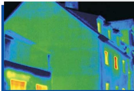
Die Thermografie macht Wärmeverluste sichtbar. Die rotglühenden Flächen auf dem linken Bild zeigen den vermeidbaren Energieverlust von jährlich ca. 800 Litern Heizöl. Auf dem rechten Bild sehen Sie das gleiche Haus mit Fassadendämmung.
